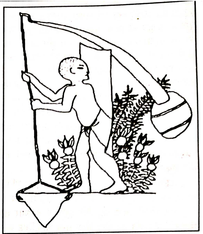
चित्र : खंभों पर संतुलित बल्ली से लटकी चमड़े की बाल्टी को नीचे करके पानी ऊपर उठाता हुआ मिस्र का एक किसान। दूसरे सिरे पर भार होने के कारण किसान को पानी ऊपर उठाने में आसानी होती है। लगभग 1500 ईसा पूर्व मकबरे की चित्रकला के प्राप्त रेखाचित्र। भारत में आज भी इस तरह का उपकरण
